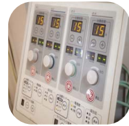
1. 儀器觸控開關 2. 電子柵欄 3. 塑膠銘板
